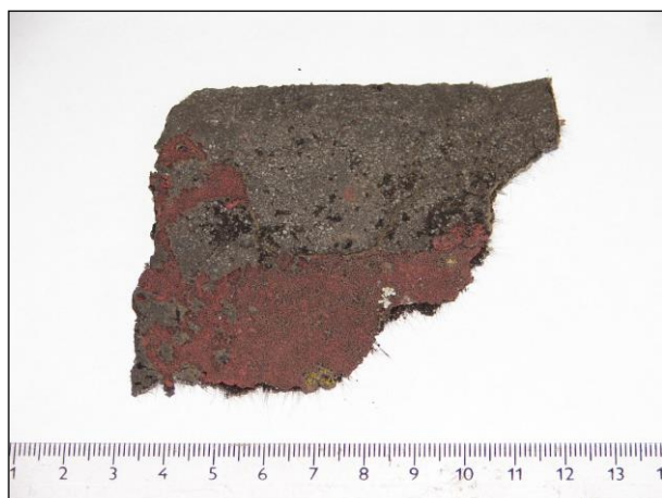
Foto 236: Asfaltová lepenka Střecha, svrchní vrstva souvrství Přítomnost azbestu jako plniva: negativní
