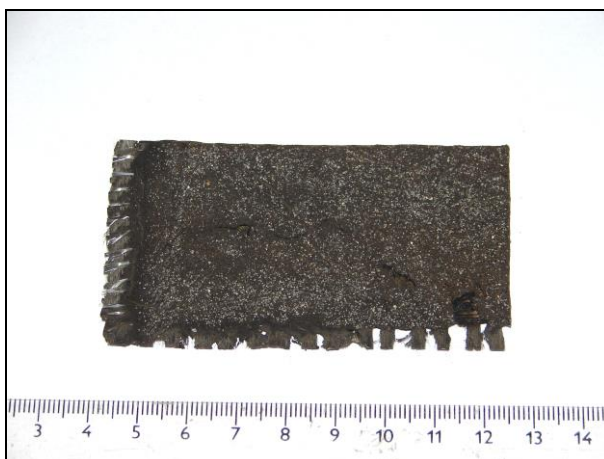
Foto 38: Asfaltový hydroizolační pás (s vložkou ze skelné tkaniny) Střecha Přítomnost azbestu jako plniva: negativní
