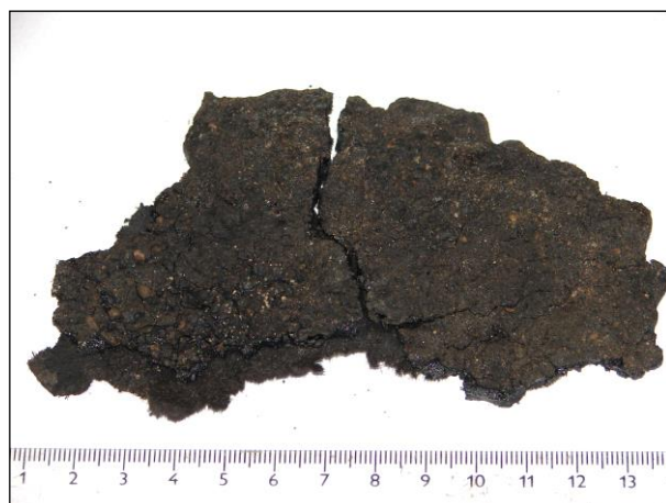
Foto 237: Asfaltová lepenka Střecha, spodní vrstva souvrství Přítomnost azbestu jako plniva: negativní
