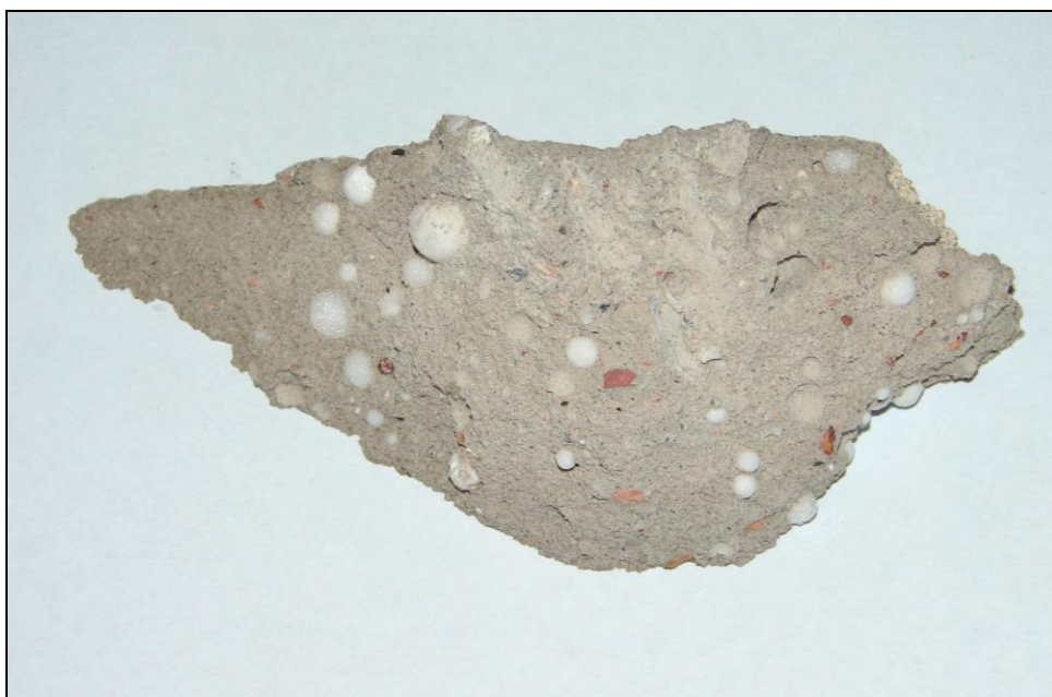
Foto 202: SO 03-55-01, domek TO, fasáda domku směrem k trati; stěny jsou montované z panelů z polystyren-betonu, tyto panely se obvykle používaly jako ztracené bednění, na vnitřních lících měly profilovaný povrch jako „plata na vejce“, panely se umístily proti sobě profilovanými povrchy, do mezery se vložila betonářská výztuž a mezera se zalila betonem
