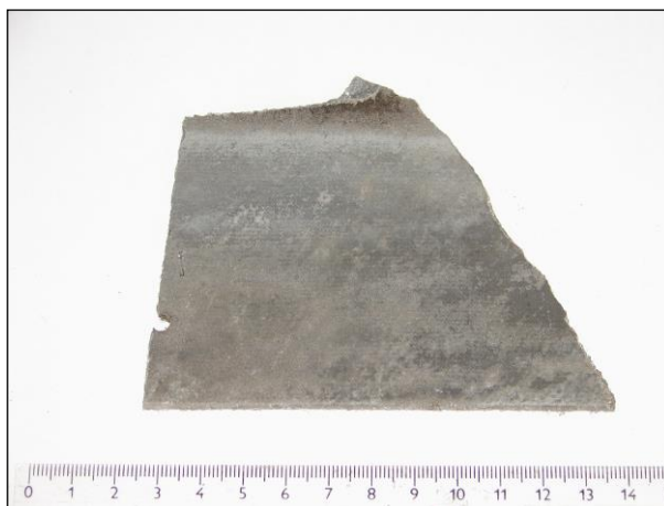
Foto 132 a 133: Střešní šablony bázi cementu Střecha Přítomnost azbestových vláken: v obou případech pozitivní
