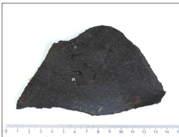
Foto 135: Asfaltová lepenka Podlaha, pod PVC Přítomnost azbestu jako plniva: negativní
