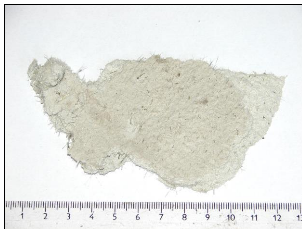
Foto 195: Ohnivzdorný materiál na bázi cementu Interiér, demolice č. 9 (rubová strana plechů v místě kamen) Přítomnost azbestových vláken: pozitivní
