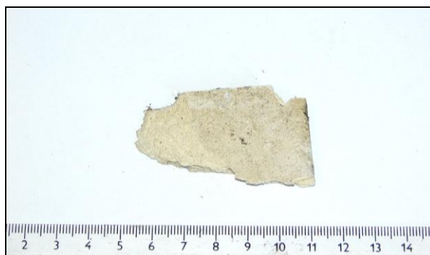
Foto 131: Deska na bázi cementu Skladovací prostory (pod osvětlením) / Nad rampami (pod osvětlením) Přítomnost azbestových vláken: pozitivní
