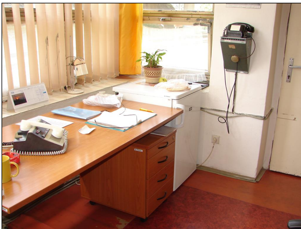
Foto 19 a 20: SO 02-55-01, hradlo Barrandov, interiér, hlavní místnost; omítnuté zděné stěny a ŽB strop, kovová okna, na betonové podlaze PVC
