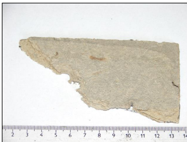
Foto 194: Deska na bázi cementu Interiér, demolice č. 9 (pod rozvaděčem el. energie) Přítomnost azbestových vláken: pozitivní
