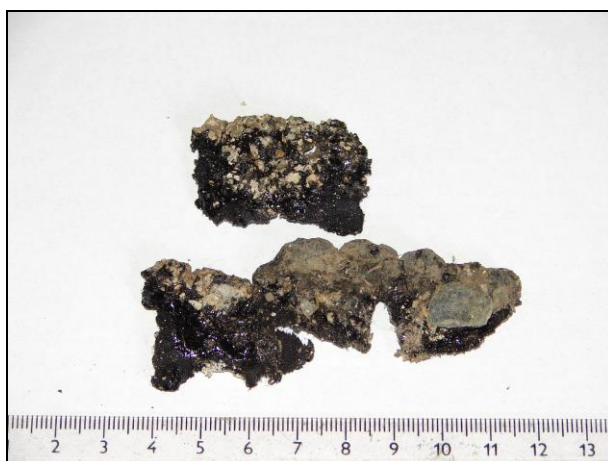
Foto 74: Asfaltová lepenka (optařená asfaltovým nátěrem) Spodní izolace stavby Přítomnost azbestu jako plniva: negativní
