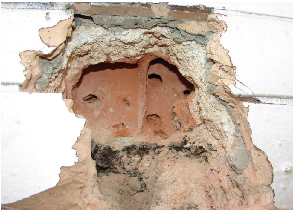
Foto 30: SO 02-55-01, hradlo Barrandov, sonda pro zjištění spodní izolace; z asfaltového hydroizolačního pásu byl odebrán vzorek (foto 37), asfaltový hydroizolační pás neobsahuje azbest jako plnivo (Příloha 2)
