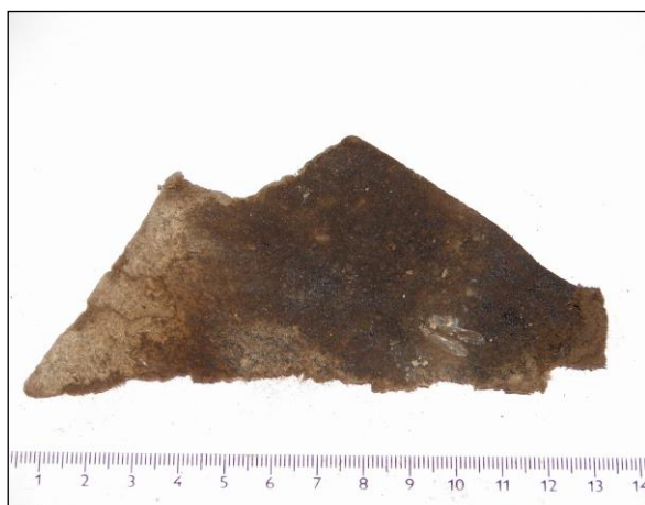
Foto 134: Asfaltová lepenka Střecha (pod šablonami) Přítomnost azbestu jako plniva: negativní
