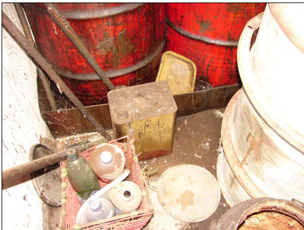
Foto 140 a 141: SO 03-55-01, zděný přístavek u skladu, interiér; oleje jsou v nádobách či sudech, sudy jsou zpravidla postaveny v plechových vanách, povrch PVC je místy od oleje, zasažení betonové podlahy olejem je povrchové, lokální, minimálního rozsahu a zcela zanedbatelné
