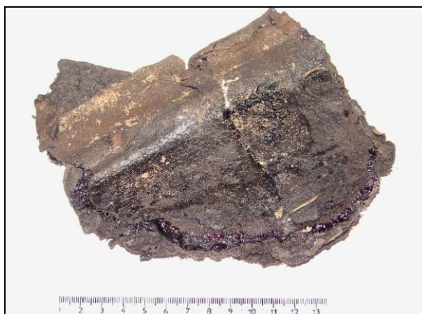
Foto 73: Asfaltová lepenka (souvrvství prokládané asfaltovým nátěrem) Střecha Přítomnost azbestu jako plniva: negativní
