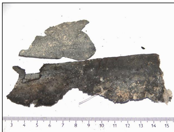
Foto 235: Asfaltová lepenka Spodní izolace Přítomnost azbestu jako plniva: negativní
