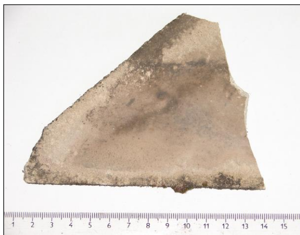
Foto 132 a 133: Střešní šablony bázi cementu Střecha Přítomnost azbestových vláken: v obou případech pozitivní
