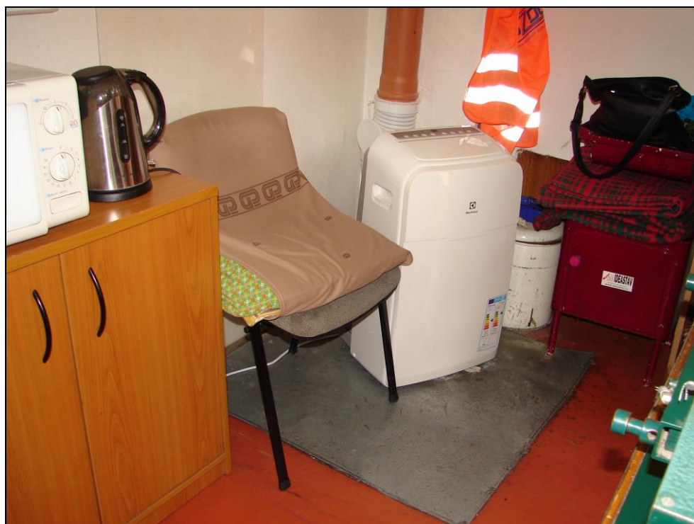
Foto 21 a 22: SO 02-55-01, hradlo Barrandov, interiér, hlavní místnost; omítnuté zděné stěny a ŽB strop, na betonové podlaze PVC, pod otopnou jednotkou prostý plech (bez ohnivzdorného materiálu na rubové straně), odtah z plastových rour
