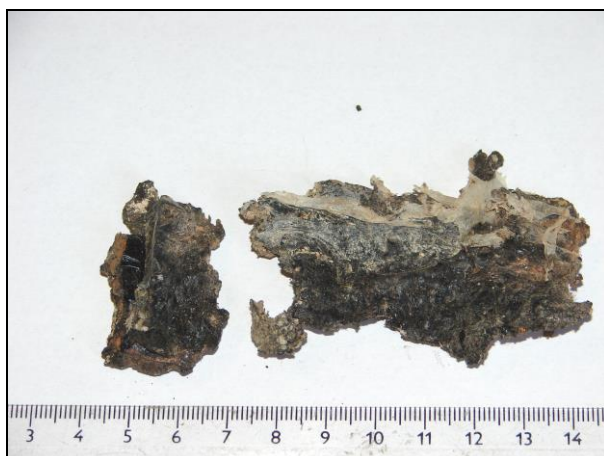
Foto 37: Asfaltový hydroizolační pás Spodní izolace stavby Přítomnost azbestu jako plniva: negativní
